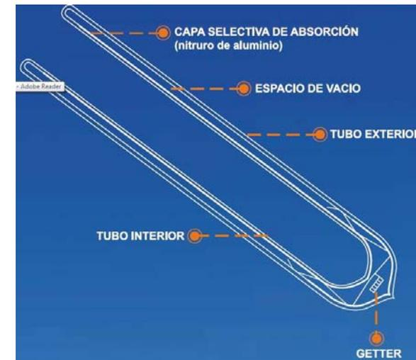
Figura 40. Componentes de los Tubos al Vacío.
