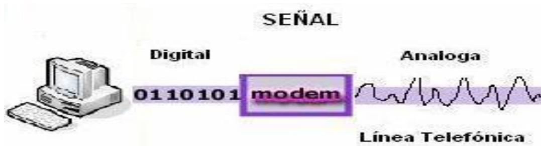
Fig. 3.1, Transformación de la señal en un módem.
