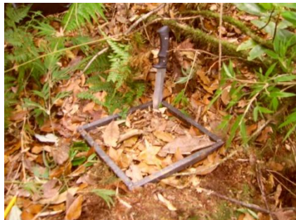
Figura 4.1.2 Muestreo de mantillo forestal en campo, se colocó el cuadrante de 25 x 25 cm, y debajo de éste se tomaron las muestras de los horizontes orgánicos y minerales.
