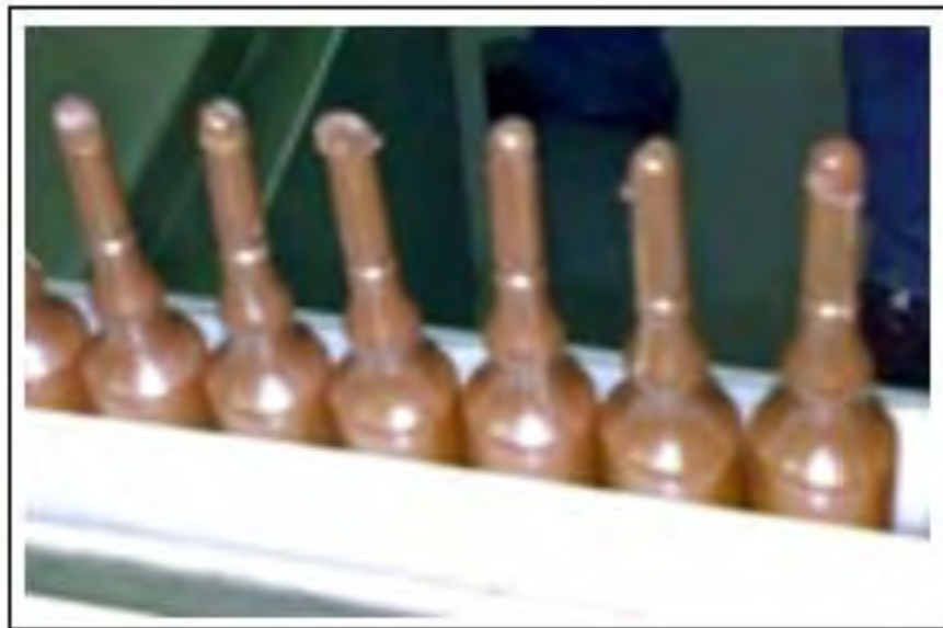
Figura 4.18, Resultado de las boquillas desalineadas.
