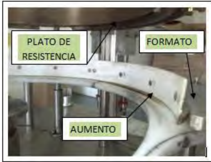
Figura 5.9, Guía para reducir la separación en apoyos.
