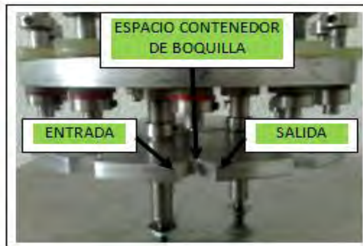
Figura 5.19, Alineación de boquilla.
