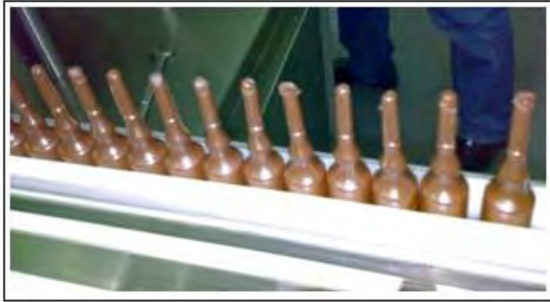
Figura 2.14, Muestra de Ampolletas procesadas en el sistema de sellado.
