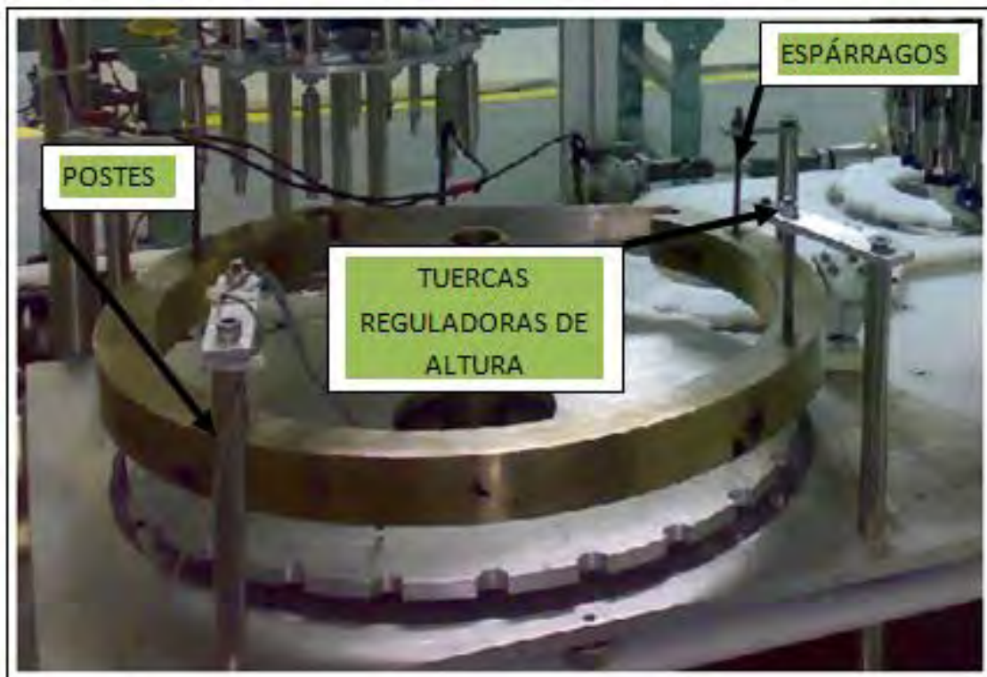
Figura 4.14, Sistema de sujeción y elevación del plato de calentamiento.
