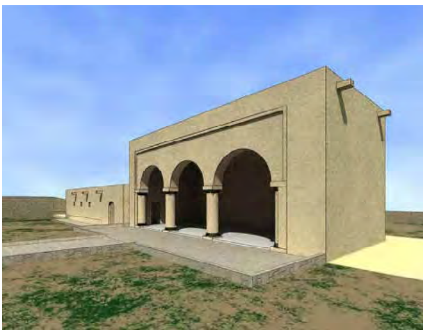
Figura 22. Reconstrucción hipotética de la capilla de San Miguel Anenecuilco, que en esta etapa constructiva ostentaba tres arcos de medio punto enmarcados por un alfiz y la cubría una bóveda más baja.
