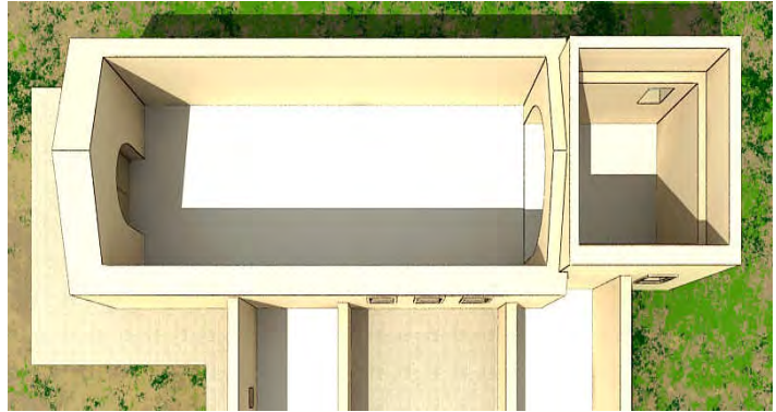
Figura 11. Reconstrucción hipotética que marca la sobreposición de los muros de del presbiterio y la nave del templo, cuyas techumbre pudieron ser de bóveda y a dos aguas, respectivamente.
