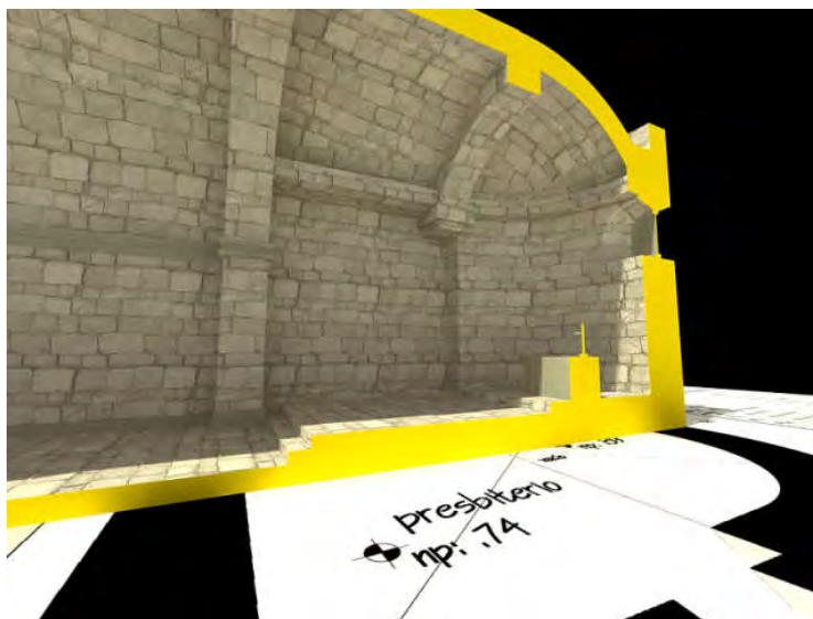
Figura 28. Corte longitudinal en el que destaca uno de los arcos fajones sobre los que descargaba la bóveda del presbiterio del templo de Ahuatlán.
