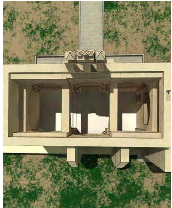
Figura 26. Reconstrucción que muestra la adición de dos pares de contrafuertes en las fachadas oriente y poniente de la iglesia de San Miguel Anenecuilco.
