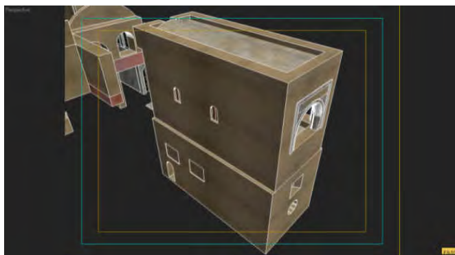
Figura 70. La reconstrucción muestra la sobreposición del mirador sobre el granero.
