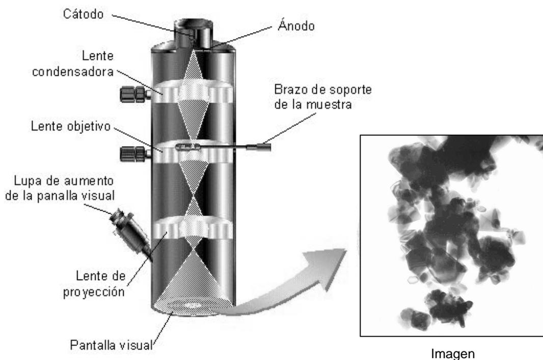
Figura 11. Estructura, funcionamiento y obtención de imágenes en un microscopio electrónico de transmisión.
