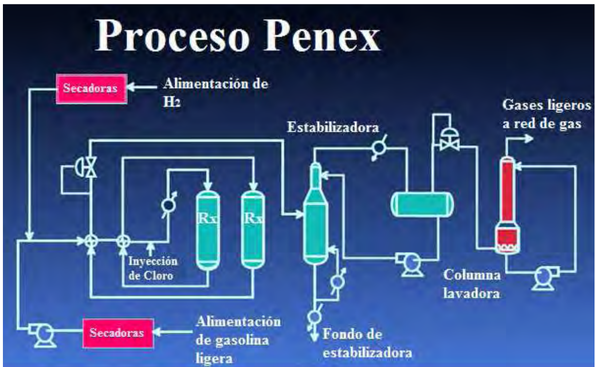
Fig. 10.- Esquema del proceso de Isomerización Penex (Hydrogen Once Through) [8].
