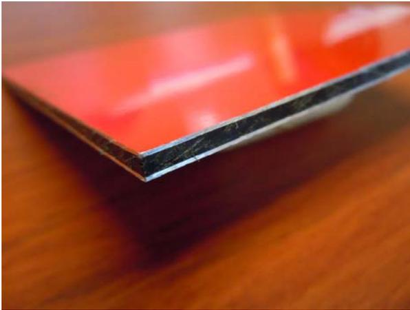
Material ALBOND de dos capas exteriores de lámina de aluminio esmaltado y central de polietileno espumado.
