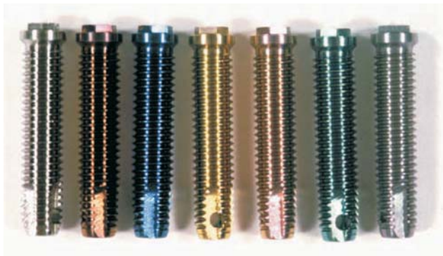
Figura 1.1: Formación de capa barrera por anodización de Ti. Dependiendo del voltaje usado se obtiene una gran variedad de colores
