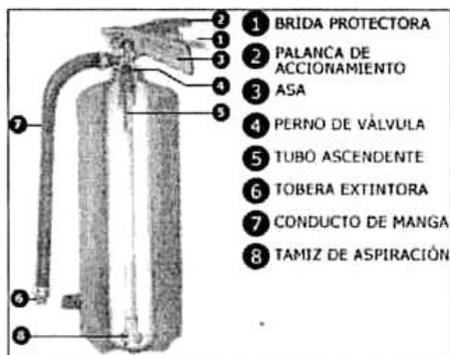
Fig. 11. Extinguidores permanente presurizados.
