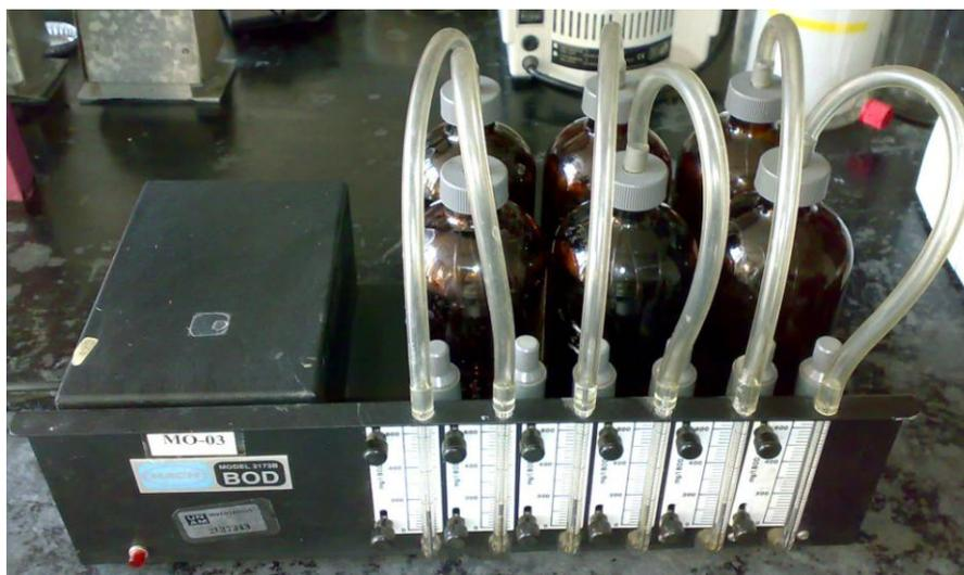
**Figura 2.4.** Equipo utilizado para la medición de DBO.
