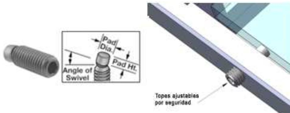
Figura 4.2: Topes ajustables montados en estructura principal
