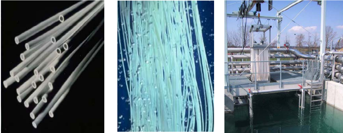
Figura 3.4 Fotografías de membranas sumergidas de fibra hueca, (Lowe, E., 2006).
