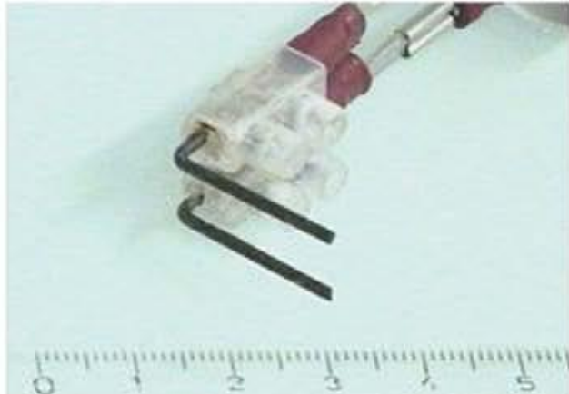
Figura 20. Foto de los electrodos de contacto. El ancho es de 9mm. La longitud es de 20mm (155).
