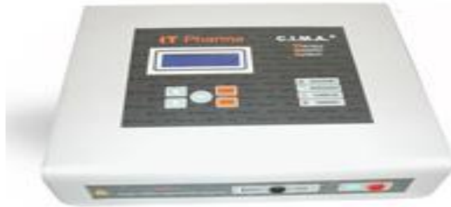
Fig. 30. Equipo que incorpora en un solo aparato la diatermia o hipertermia y la electroporación.
