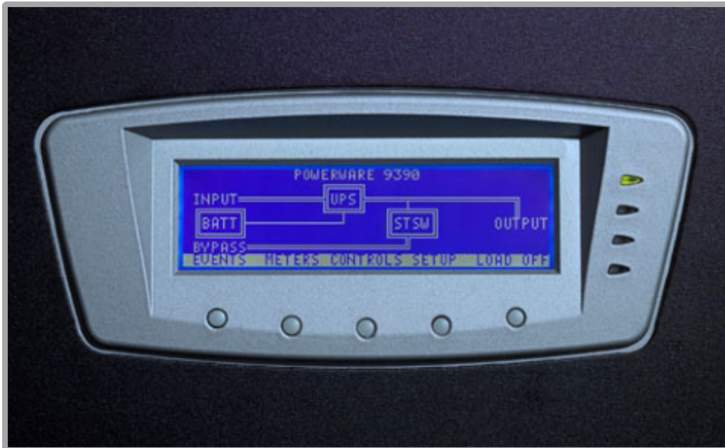
Figura 3.18 Pantalla LCD y sus componentes principales.
