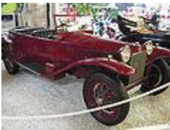
Lancia Lambda, primer vehículo con carrocería autoportante
