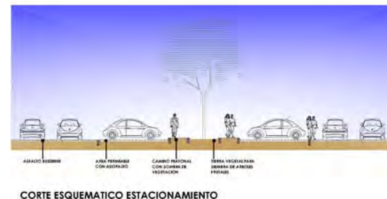
97. Imagen que indica la propuesta de rehabilitación de las áreas de estacionamientos
