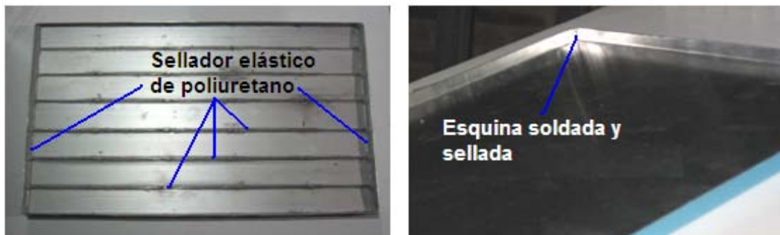
Foto 5. Esquinas y uniones de la base y tapa selladas con poliuretano.
