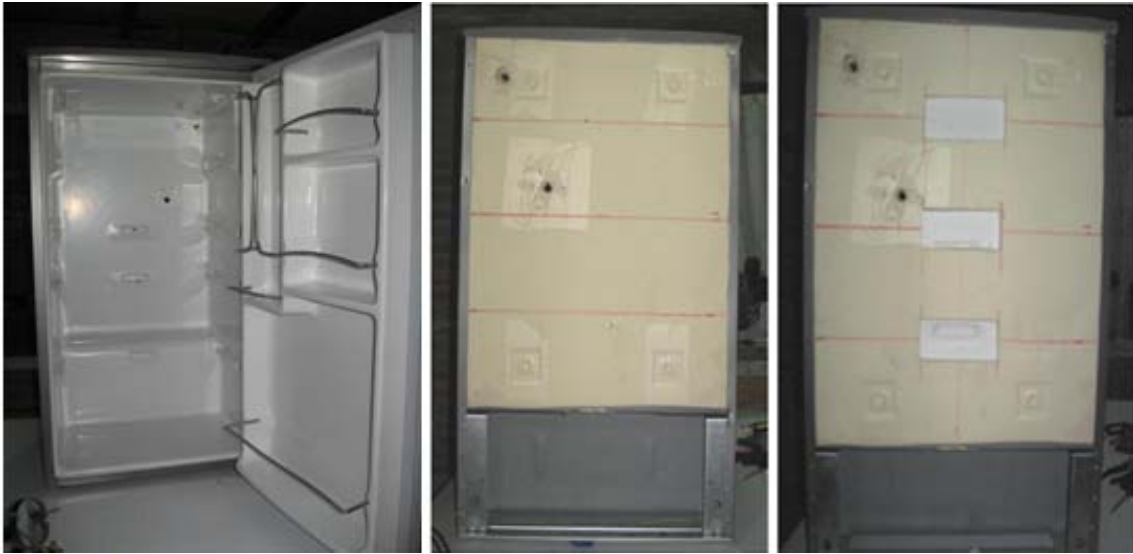
Foto 1. Etapas del proceso de corte en la pared trasera del dispositivo de enfriamiento para el montaje de los ensambles termoeléctricos.
