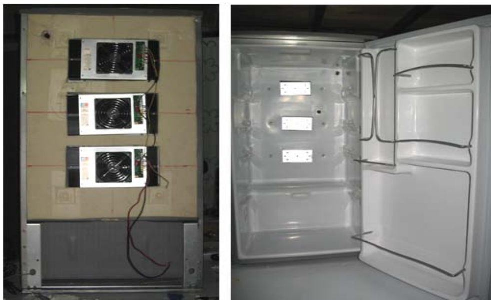
Foto 2. Ensamblados termoeléctricos montados en la pared trasera del dispositivo de enfriamiento.
