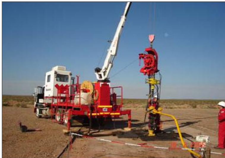
Figura 1.3. Sistema de tubería capilar
