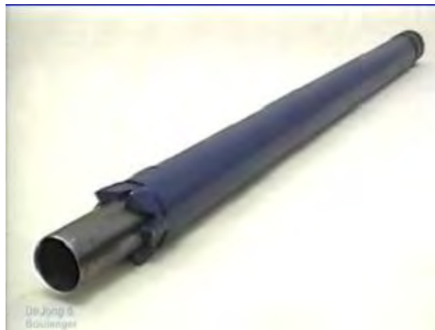
Figura 6.2. Muestreador Denison. Tomado de ocw.uis.edu.co/.../PERFORACION_Y_MUESTREO_DE_SUELOS
