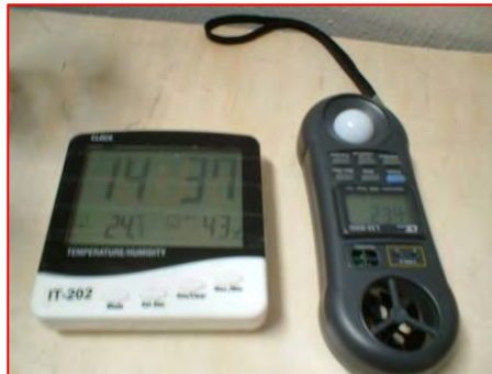
Figura 3.3.2 Higroómetro, reloj y termómetro, marca IT-202. Medidor de ambiente marca Lutron modelo LM-8000, 4 en 1 Aneómetro, higroómetro, medidor de luz y termómetro.
