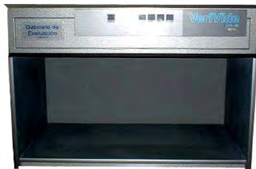
Figura 2.7.37. Las características relevantes que deben cubrir las cabinas de iluminación empleadas para la comparación de color están descritas en diversas normas internacionales entre las que se encuentran: ISO 3664:2000, ASTM D1729-96, ASTM D2616-96, ASTM D4086-92a. (Adaptado de: Carlos H. Matamoros. División de Óptica y Radiometría, Centro Nacional de Metrología, 2006)
