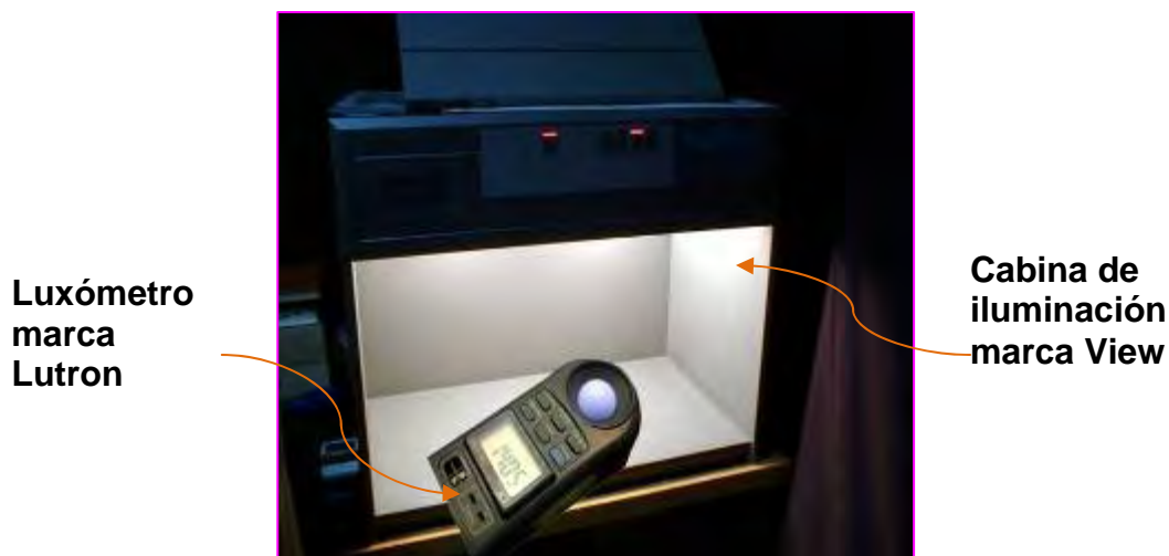
Figura 2.7.41. Regularmente las cabinas de iluminación se ubican en un lugar con paredes oscuras, para evitar reflectancia. (Imagen de archivo personal, 2008).
