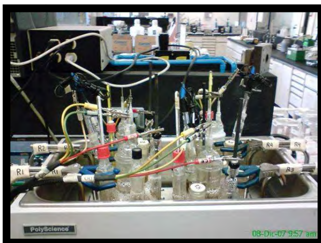
En la fotografía se aprecian las cuatro celdas electroquímicas utilizadas durante la experimentación, sumergidas parcialmente en un Baño María a 37 °C.
