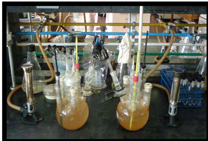
Figura No. 15. Inoculación de celdas electroquímicas en un ambiente estéril
