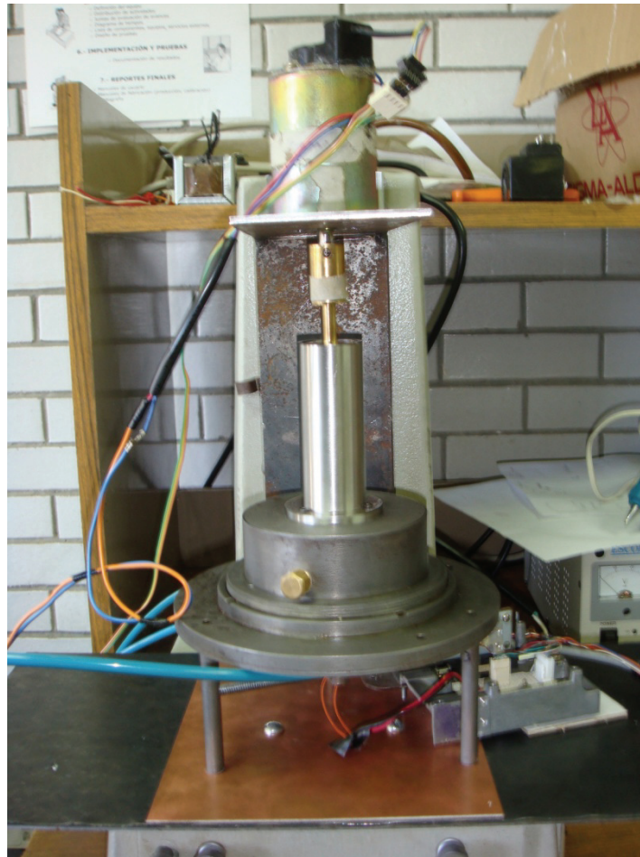
Figura 6-1 Montaje del viscosímetro existente.
