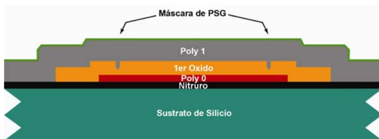
Figura B.7 Una capa de 2\mu\text{m} de polisilicio es depositada seguida de una capa de 200nm de PSG.
