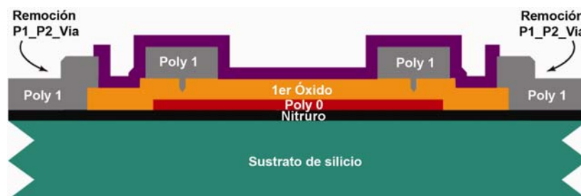
Figura B.10 La oblea es cubierta con fotorresist y el quinto nivel (Poly1_Poly2_Vía) es dibujado con litografía.
