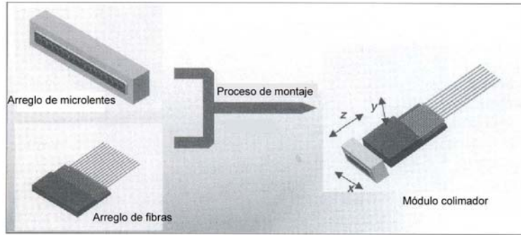
Figura 2.15. Montaje del arreglo de microlentes con el arreglo de fibras ópticas.
