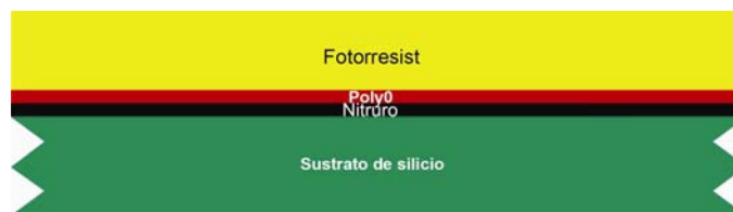
Figura B.1 El fotorresist es dibujada con litografía por exposición de luz UV a través de la primera máscara.
