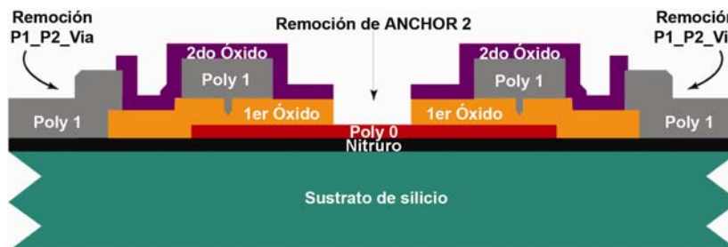
Figura B.11 La oblea es recubierta con fotorresist y ANCHOR2 es dibujado con litografía. Los dos óxidos son removidos mediante RIE y ANCHOR2 provee de contacto a Poly2 con el Nitruro o con Poly0.
