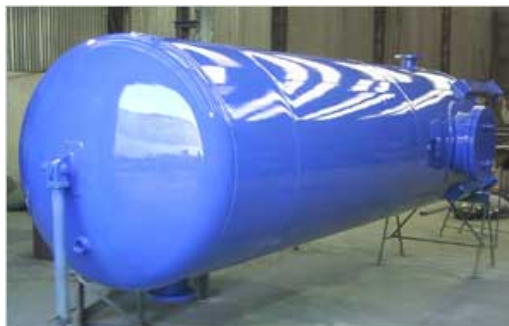
Figura 47. Fotografía de un Separador horizontal (equipo nuevo)
