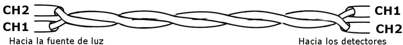
Fig. 2.6. Trenzado de fibras ópticas para el proceso de fusión.
