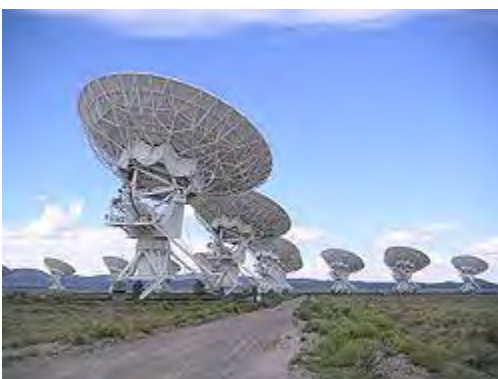
Radiotelescopio Very Large Array (VLA), en Socorro, Nuevo México, este telescopio es un array interferométrico compuesto por 27 antenas.
