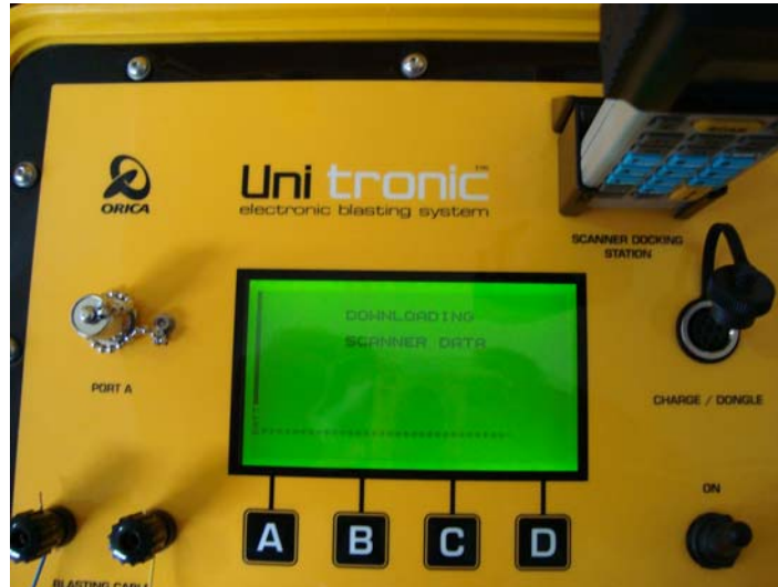
Figura 29. Blast Box descargando la información de los iniciadores Unitronic
