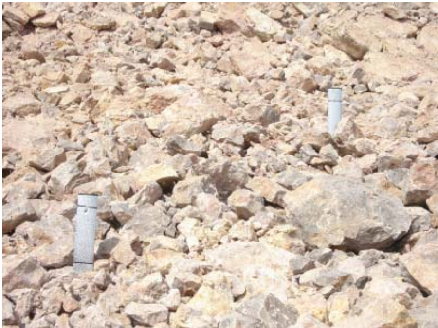
Figura 26. Fotografía tipo para análisis de fragmentación
