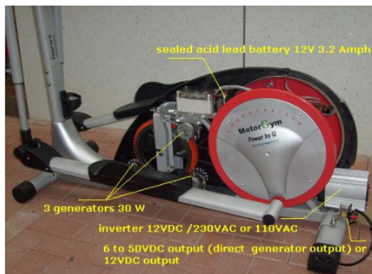
Imagen 2. Elíptica con capacidad para generar energía eléctrica a partir del ejercicio cardiovascular. 29
