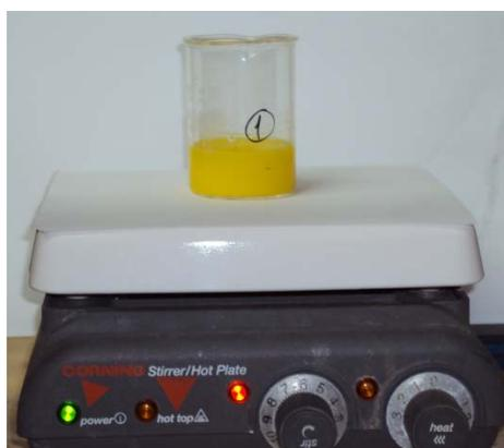
*Fig. 3.1 Obtención de nanopartículas de CdS por precipitación química (Experimento 2)*
