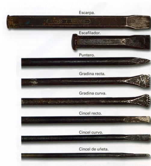
Como más arriba se mencionó, depende de la herramienta que se utilice el resultado de la talla y como ejemplo se puede ver el proceso en piezas inacabadas griegas donde solamente se utilizaba el puntero y se devastaba simultáneamente por las cuatro caras de la figura, posteriormente se iba afinando con un puntero mas fino y se terminaba con abrasivos. En este caso
