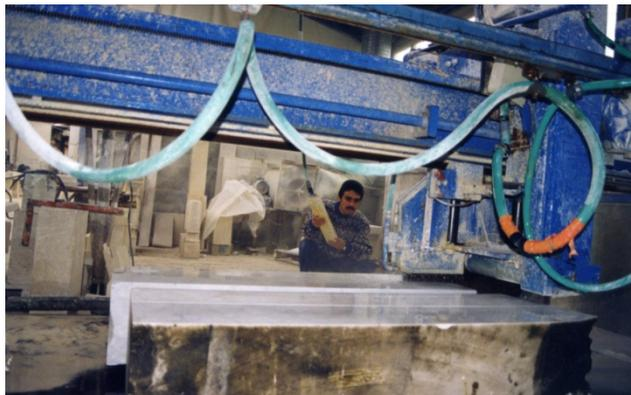
Proceso de corte de las piezas de mármol con una máquina (Foto de Horacio Castrejón G.)
