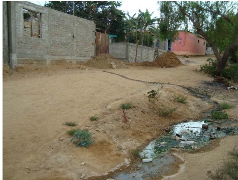
Imagen. Se puede observar la falta del drenaje.
