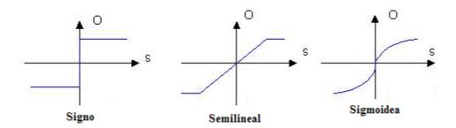
Figura 1.4. Graficas de la función de transferencia para la activación de la neurona.
