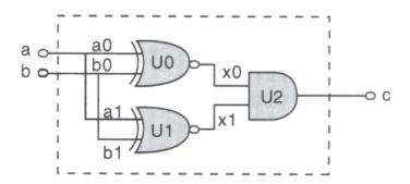
Figura 3.9. Representación esquemática de un comparador de 2 bits
