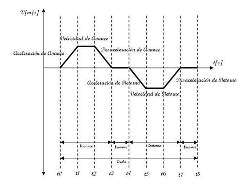
Figura 6.3 Ciclo de trabajo del eje X del SRC
