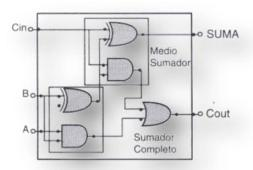
**Figura 3.1**. Arquitectura de un sumador completo a nivel de compuertas.
