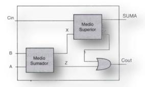
**Figura 3.3**. Integración de varios subsistemas (medio sumador) puede representarse mediante una entidad.
