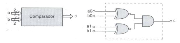
Figura 3.8 Diagrama de circuito comparador
