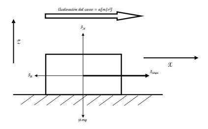
Figura 6.3 Diagrama del cuerpo libre para el eje X
