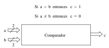
Figura 3.7. Descripción funcional de un comparador de igualdad de dos bits
