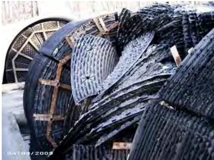
Figura 2-7. Rompimiento del material de fijación
