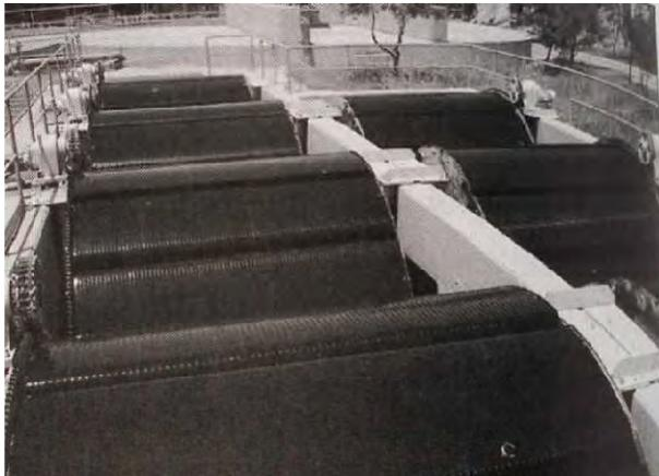
Figura 3-1c. Foto de biodiscos con un flujo perpendicular al eje
