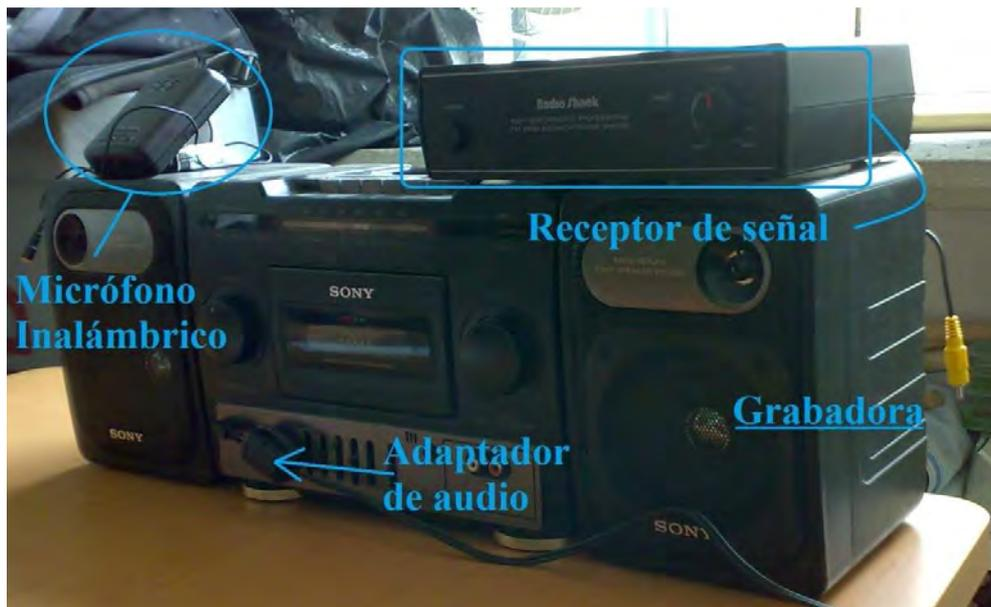
Figura A-1. Equipo utilizado en la medición del caudal de descarga de la DICyG
