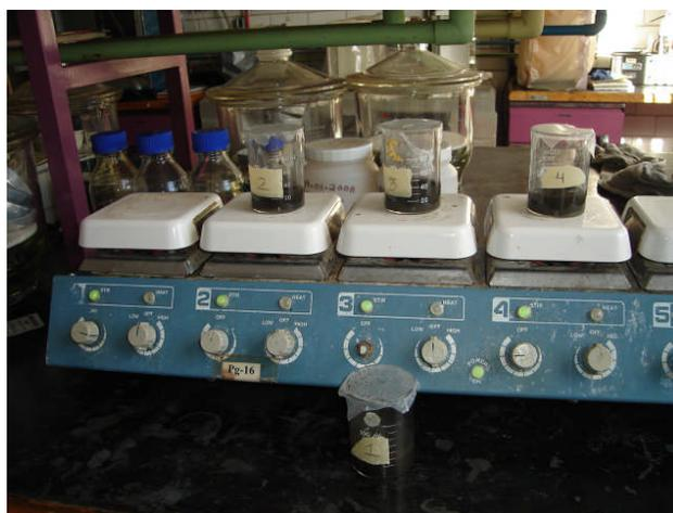
Figura IV.23. Agitación de muestras de jal para determinación de pH y CE
