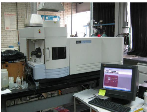
Figura IV.25. Espectrómetro ICP-OES
