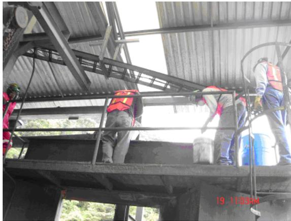
Figura IV.9. Muestreo de efluente de flotación y jales en Cárcamo de Bombeo (CB) a la presa de jales (Sep07)
