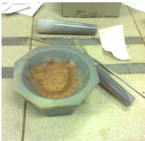
Figura IV.20. Trituración de jal en un mortero de ágata
