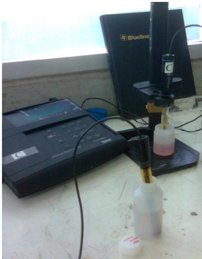
Figura 3.1. Medición de potencial redox en lixiviados de celdas
