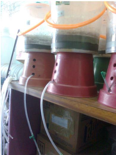
Figura IV. 12. Lixiviado de una celda: Manguera de Salida del lixiviado
