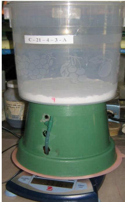
Figura 3.3. Celda vacía con medio de soporte
