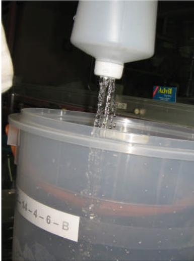
Figura IV. 10. Lixiviado de una celda: Adición de agua Desionizada
