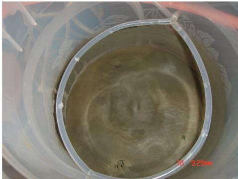
Figura 3.4. Interior de celda con jal y difusor de aire
