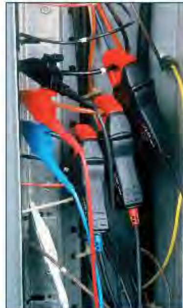
Mide el voltaje y la corriente de las tres fases simultáneamente.
