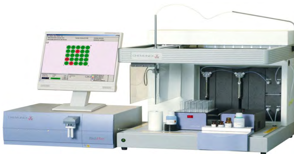
Figura 3.3.2 c) Bactiflow ALS ® Capacidad de 25 pruebas con resultado en un tiempo de 90 minutos.
