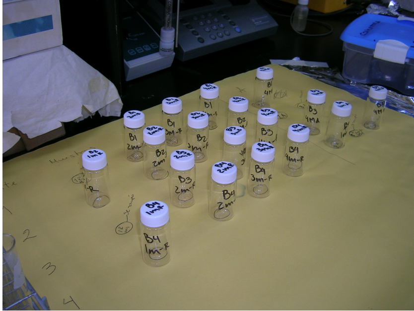
Imagen 5. Viales de vidrio para centelleo, en los cuales las muestras se incubaron con metanol
