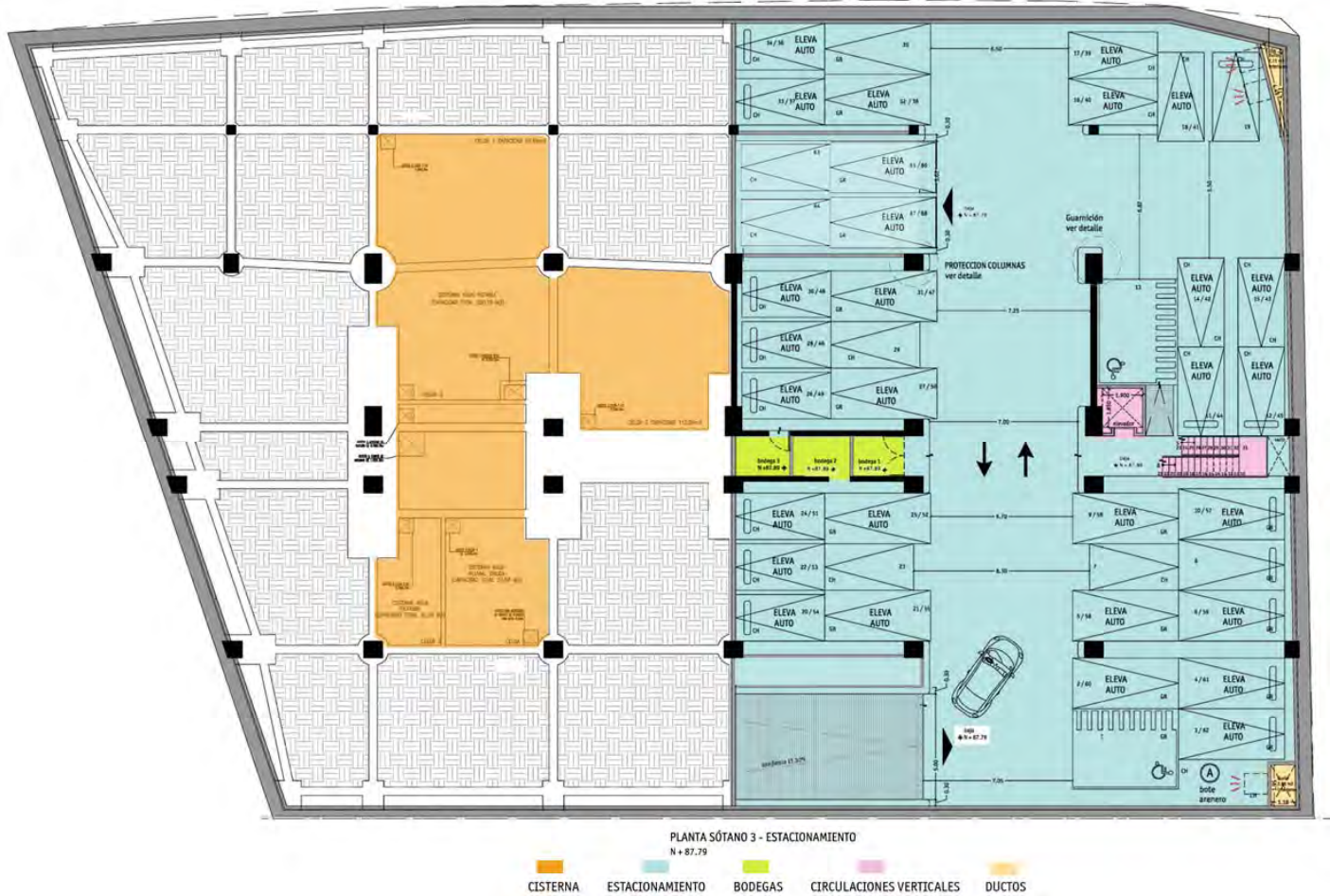
Gráfico 127.- Planta de sótano 3 (estacionamiento)
