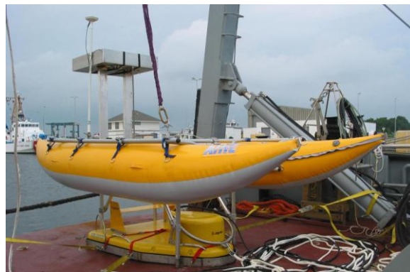
Figura I.18) Sistema chirp, montado en un trineo flotante. (Mosher y Simpkin 1999).
