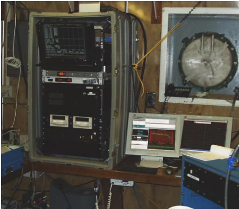
Figura II.20) Sistema Adquisición de Datos Sísmicos. (J.Ramírez,2006,Moana Wave)
