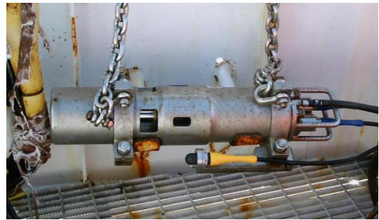
Figura II.21) Pistola de Aire(90 Inch 3 ), Fuente Sísmica. (J.Ramírez,2006,Moana Wave)
