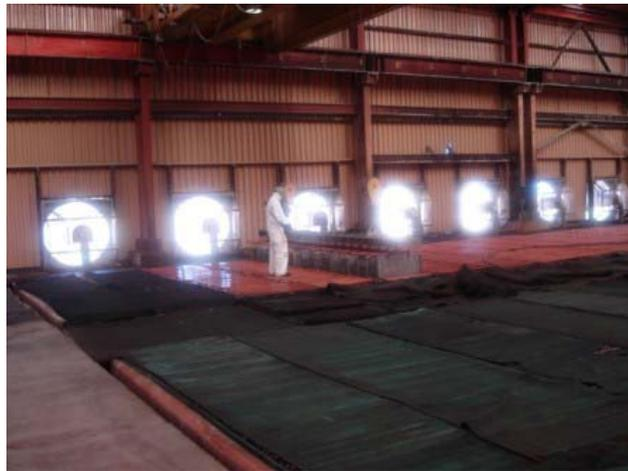
Figura 1.1 Nave de electrodeposición de cobre.
