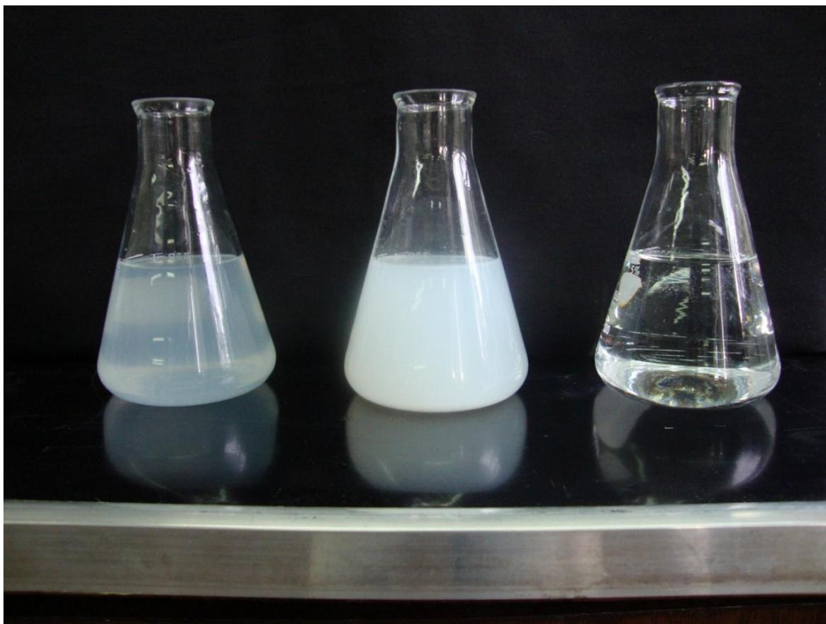
Figura 4.1 Agua gris tratada con hidróxido de calcio. Los matraces de izquierda a derecha, muestran las tres etapas del tratamiento: agua gris, precipitado y agua resultante.
