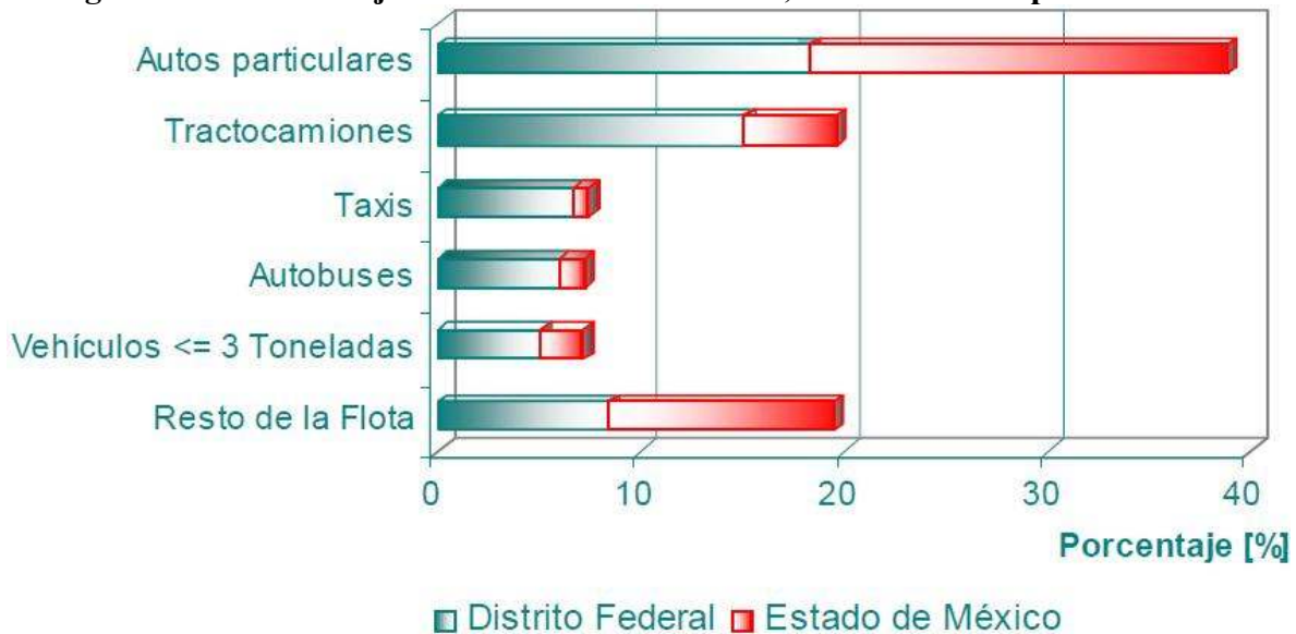
Figura 2.37. Porcentajes de las emisiones de NO x , de acuerdo al tipo de vehículo
