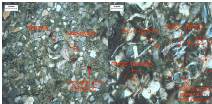
Figura II.5.5.22. Núcleo C. Arenisca lítica (litarenita) volcánica. Unidad de roca UR-7.
