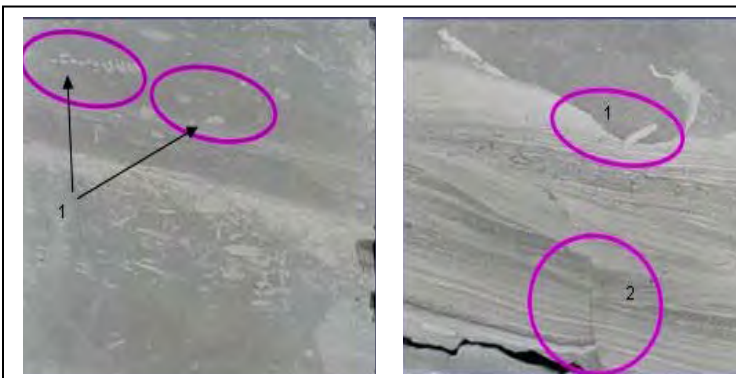
Figura II.6.1.6. Bioturbación (1) observada con baja frecuencia en núcleo H, contacto abrupto y microfalla (2).
