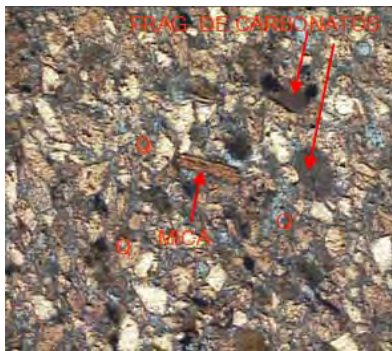
Figura II.5.5.10. Parte inferior del Núcleo E. Areniscas líticas de grano muy fino, cuarzo, fragmentos de carbonatos, micas y granos subredondeados con buena clasificación.
