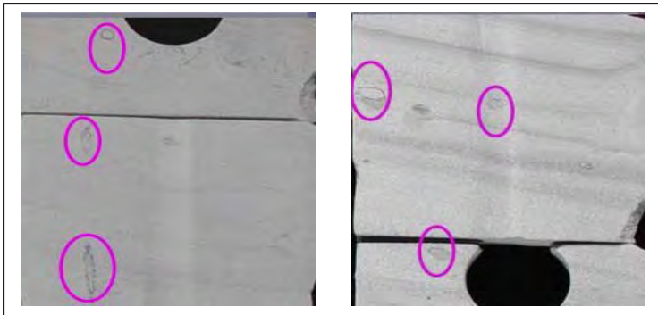
Figura II.6.1.5. Bioturbación observada con baja frecuencia en núcleo H.
