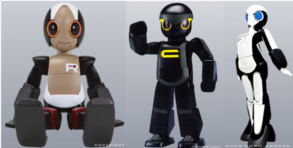
Figura 1.9: Humanoides de pequeña escala diseñados por el profesor Takahashi: Ropid, Chroino, y Female Type. Tienen una altura de 0.38[m], 0.35[m] y 0.35[m], respectivamente.
