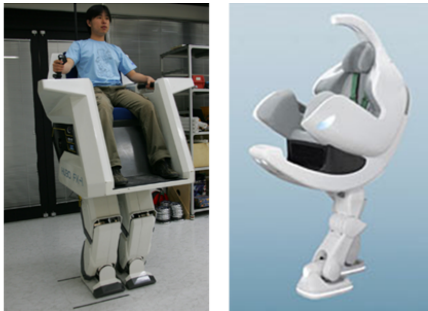
Figura 1.6: Bípedos para el traslado de personas discapacitadas. FX-1 del Hubo Lab y i-Foot de Toyota.
