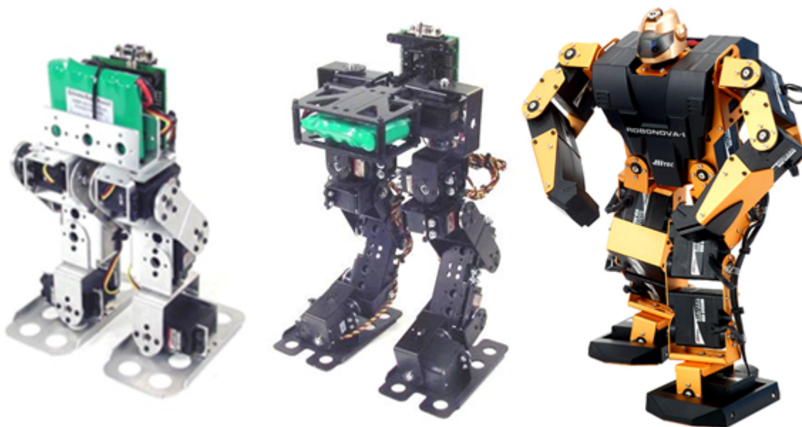
Figura 1.11: Bípedos al alcance del consumidor. BRAT (3 GDL por pierna), Scout (6 GDL por pierna) y Robonova.
