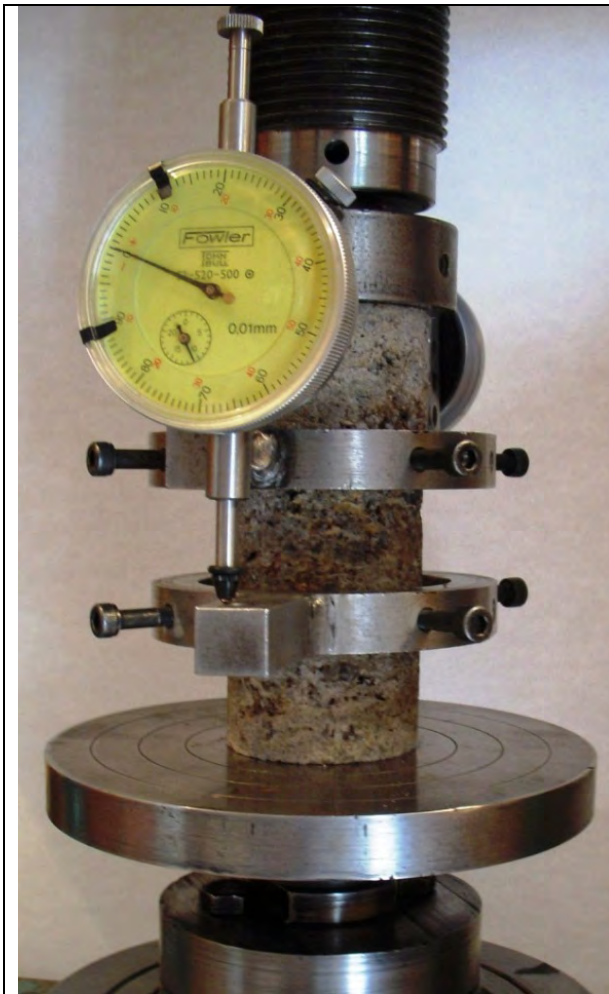
Fotografía A4.5 Ensayo de compresión simple con medición de deformaciones en el núcleo de Tobas- Muestra M-2 (km 17+000).
