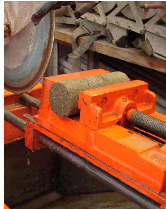
Fotografía A4.1 Corte de las caras extremas de los núcleos de roca a ensayar.
