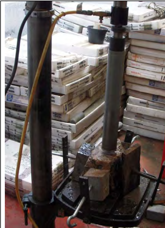
Fotografía A4.3 Extracción de núcleos de roca mediante una perforadora de banco.
