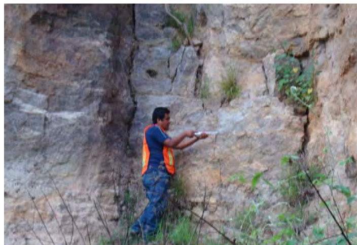
Fotografía V.5 Toma de datos con martillo de Schmidt
