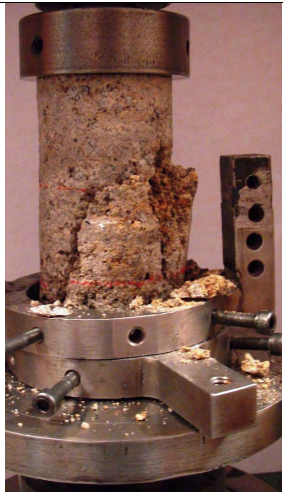
Fotografía A4.6 Modo de falla de la muestra de Tobas sometida a compresión simple.
