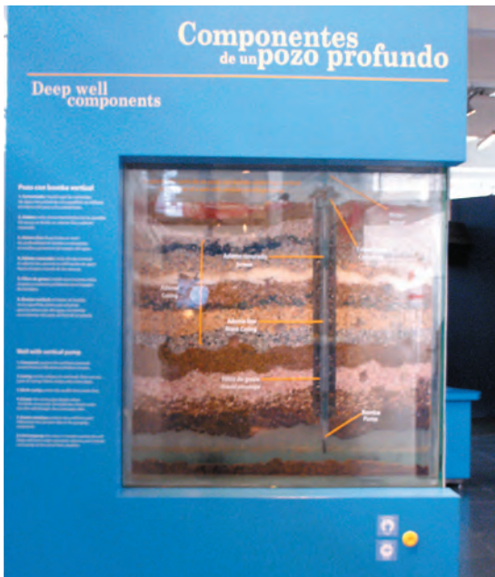
Imagen 67. Maqueta de pozos profundos ubicada en la sala de tratamiento de aguas del MUMCI (Lado de bomba centrífuga vertical)
