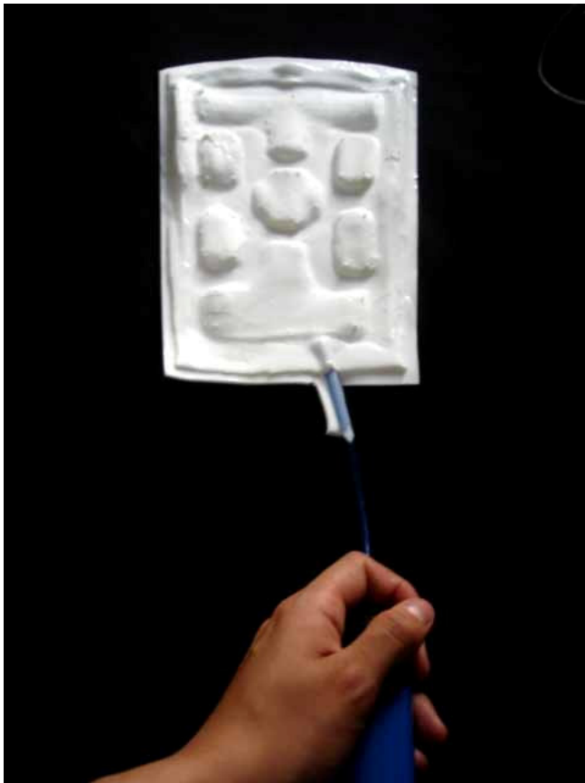
FIG.32 Moldes para la fabricación de las bolsas de silicón y manera de inflar el sistema
