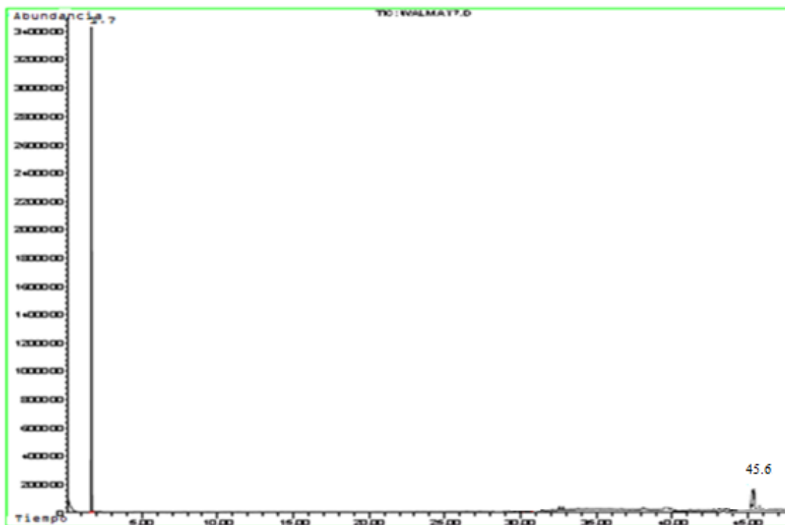
Figura 40.33 Cromatograma de la alícuota extraída del MM a las 44 h del compuesto BHET-MDI (NCO/OH 2:1) incubado en MM sin cepa bacteriana.
