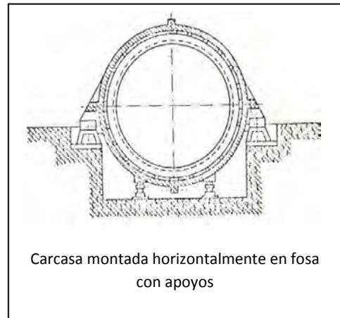
Figura 1.3 Carcasa del Estator
