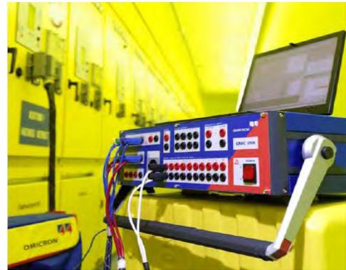
Figura 4.2 Equipo de prueba de relevadores de protección
